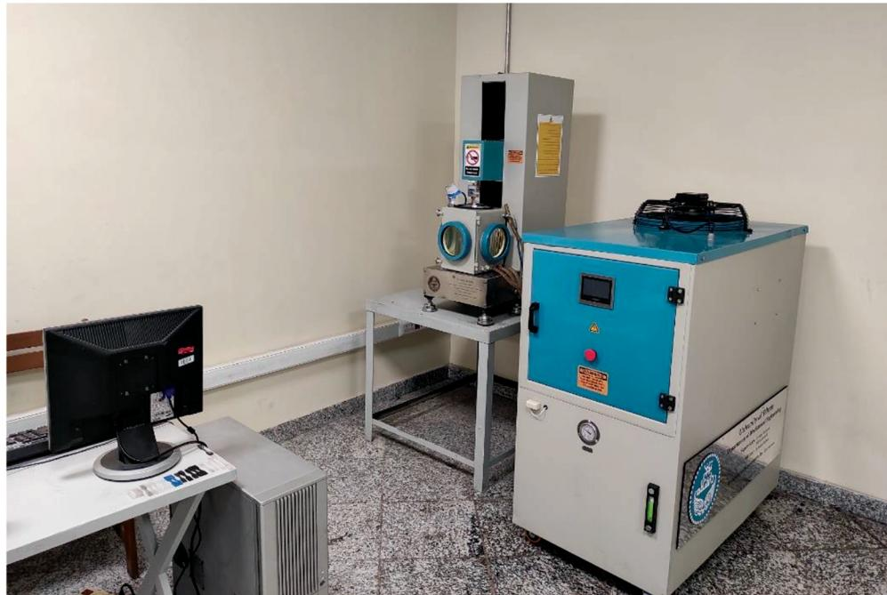
اطلاعات مربوطه به صورت عکس، نمودار،داده های اکسل، چرخه حافظه شکلی و...، به کاربر داده می شود. هم زمان با شروع تست، دوربین فیلمبرداری با وضوح بالا، از دریچه های تعبیه شده اطراف محفظه آزمایش، عمل فیلمبرداری و عکس برداری را انجام داده که در پایان با انتقال فیلم و عکس ها به نرم افزار پردازش تصاویر، اطلاعات مربوط به میزان بازیابی شکل، میزان ثبیت شکل و غیره، استخراج می گردد
